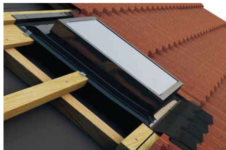
Attēls 52: Jumta logs ar pieslēgumu - šķērsgriezumā
