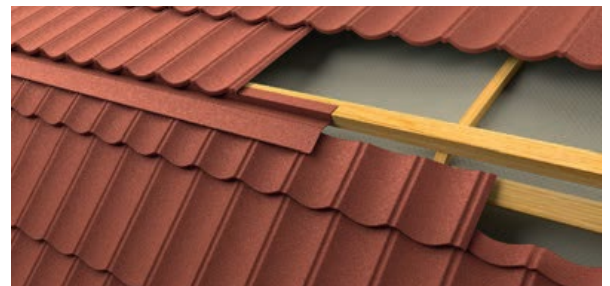
Attēls 47: Montāža jumta slīpnes ārējā lūzumā
