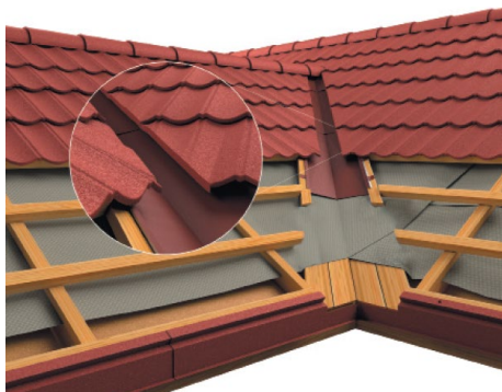
Attēls 37: Satekas montāža
