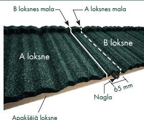
Attēls 13: Shake profila stiprināšana
