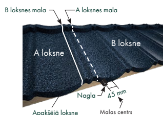
Attēls 12: Bond profila stiprināšana
